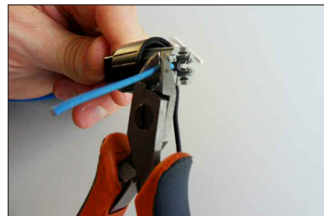
4. Überstehende Aderenden bündig (also ohne Überstand) abschneiden. Hierzu eignet sich ein Seitenschneider.
