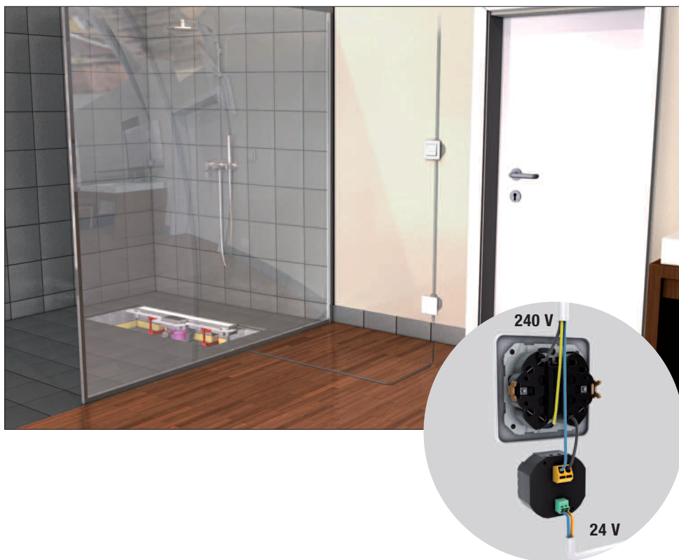
Einbau mit Bewegungsmelder
