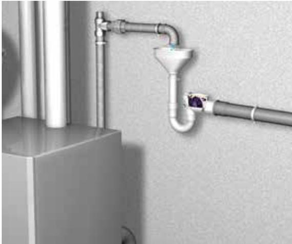
Der Rückstauverschluss *Staufix Siphon* in der Nennweite DN 50 dient als Absicherung einzelner Ablaufstellen wie Waschbecken, Dusche oder Waschmaschine in Räumen unterhalb der Rückstauenebene. Er ist in Ablaufgarnituren verbaut und steht als Siphon für Waschtische und mit Einlauftrichter für den Notüberlauf von Heizungen zur Verfügung.
