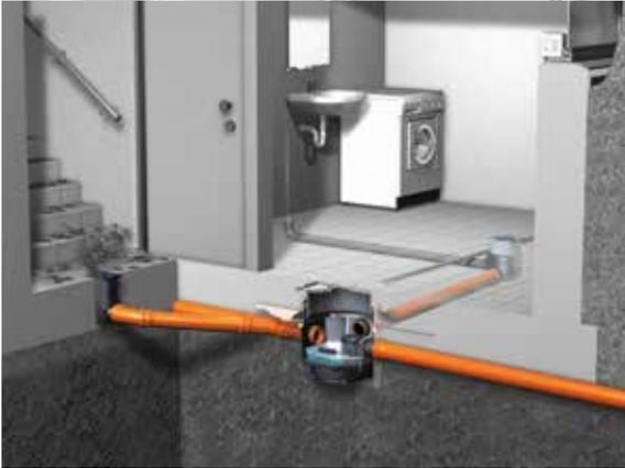
Pumpfix S ist der einzige Kellerablauf mit Rückstauverschluss, der gegen Rückstau pumpt. Er entsorgt fäkalienfreies Abwasser kontinuierlich über das freie Gefälle zum Kanal hin – auch bei Wasserrohrbruch oder eindringendem Hochwasser. Bei Rückstau schaltet sich die Pumpe automatisch hinzu und entwässert sicher gegen den Rückstaudruck. Ideal auch zur frostfreien Entwässerung eines Kellertreppenabgangs im Außenbereich.
