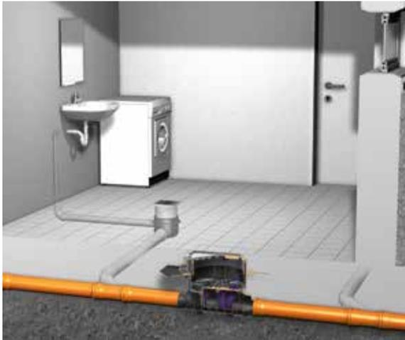
Der Rückstaudoppelverschluss *Staufix SWA* bietet mit zwei Pendelklappen doppelt sicheren Schutz vor Rückstau von fäkalienfreiem Abwasser. Bei Rückstau verhindert die äußere Klappe bereits das Eindringen von Wasser. Ein handverriegelbarer Notverschluss sorgt für zusätzliche Sicherheit. *Staufix SWA* eignet sich für Duschen, Waschbecken und Waschmaschinen im Keller.
