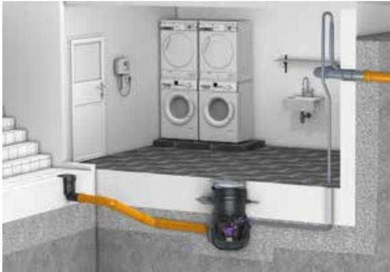
Die Hebeanlage *Aqualift S Compact* entsorgt zuverlässig und hygienisch fäkalienfreies Abwasser über eine Druckleitung in den Kanal. Sie ist sowohl mit Schwimmersteuerung als auch mit Sondensteuerung erhältlich. Das dreh-, neig- und höhenverstellbare Aufsatzstück ermöglicht beim Einbau einen stufenlosen Höhen- und Niveaueingleich und eine Anpassung an das Fliesenraster.
