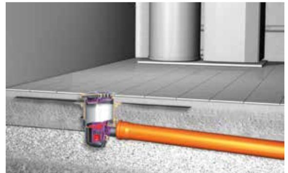
Die Leichtflüssigkeitssperre ist ein Ablauf speziell für den Heizungsraum im Keller. Er nimmt Oberflächenwasser durch einen Schlitzrost aus Kunststoff auf und leitet es in den Kanal ab. Gelangen Leichtflüssigkeiten wie Heizöl in den Ablauf, sorgt ein Schwimmer dafür, dass das verunreinigte Abwasser nicht in den Kanal gelangen kann.
