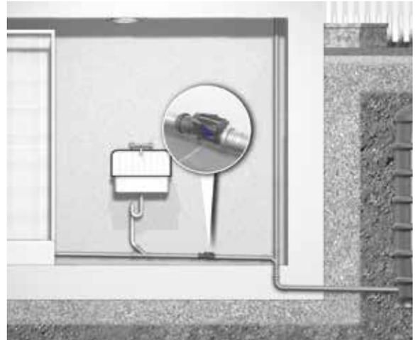
Der Rückstauverschluss *Staufix DN 50* bzw. *Staufix DN 70* dient als Absicherung einzelner Ablaufstellen wie Waschbecken, Dusche oder Waschmaschine in Räumen unterhalb der Rückstauenebene oder als zentrale Rückstausicherung in horizontalen Abwasserleitungen, auch wenn mehrere Entwässerungsgegenstände des Kellers angeschlossen sind.
